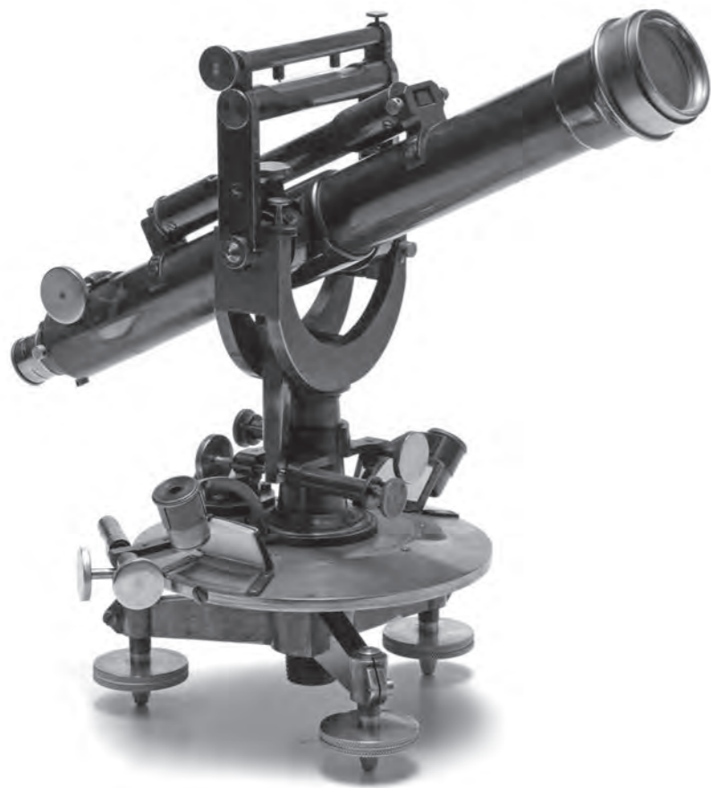
Theodolit von C. Sickler in Karlsruhe, Baujahr um 1910
