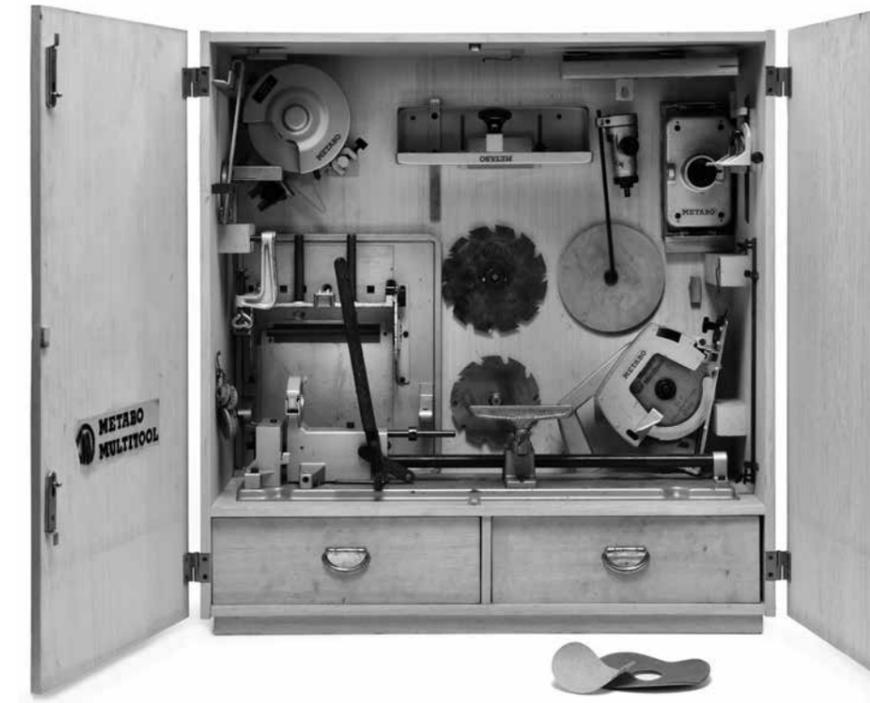
getrieben werden konnten. Zur Ausrüstung gehören eine Drechselbank, Schleifmaschine, Stich-, Kreis- und Dekupiersäge, Schwing schleifer, Tischfräse, Abrichthobelmaschine und schließlich auch noch eine Heckenschere. Was leider noch nicht aufgetrieben werden konnte, ist der in diesem System ebenfalls angebotene Rasenmäher, der seinen Antrieb ebenfalls über besagte Bohrmaschine erhielt.
